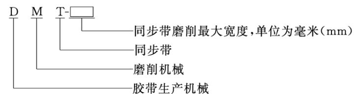
示例:DMT-1000 表示最大磨削宽度为 1 000 mm 的同步带磨削机。
